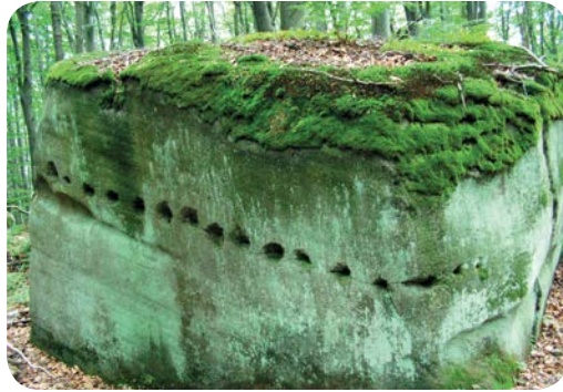
Blok do odłupania widoczne fory-otwory na kliny, fot. Emil Kania
