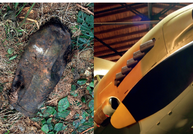
Przestrzelona rura wydechowa silnika Mikulina AM-38 (AM-38F) i jej umiejscowienie w samolocie Il-2, eksponowanym w Muzeum Lotnictwa w Pradze (fot. autora / Wikipedia commons)
